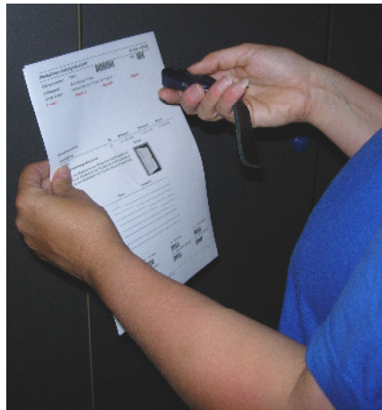
Auftrag (Strichcode) und die auszuführende Tätigkeit werden mit dem MiniScanner erfasst
