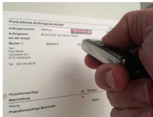
Auftrag (Strichcode) und die auszuführende Tätigkeiten werden mit dem Mini Scanner erfasst
